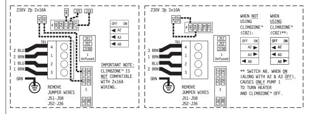
SWITCHBANK S1 OFF SWITCHBANK S1 ON 230V 1þ TEST MODE OFF **◀** A1 TEST MODE ON 1x32A DON'T ADD 1 HS PUMP W/HTR **■** A2 ADD 1 HS PUMP WITH HEAT DON'T ADD 2 HS PUMPS W/HTR ■ A3 ADD 2 HS PUMPS WITH HEAT DON'T ADD 4 HS PUMPS W/HTR ◀ A4 ADD 4 HS PUMPS WITH HEAT SPECIAL AMPERAGE RULE A **⋖** A5 SPECIAL AMPERAGE RULE B STORE SETTINGS\* ◀ A6 MEMORY RESET\* 1 MIN HTR COOLDOWN (ELEC) 5 MIN HTR COOLDOWN (GAS) ■ A7
